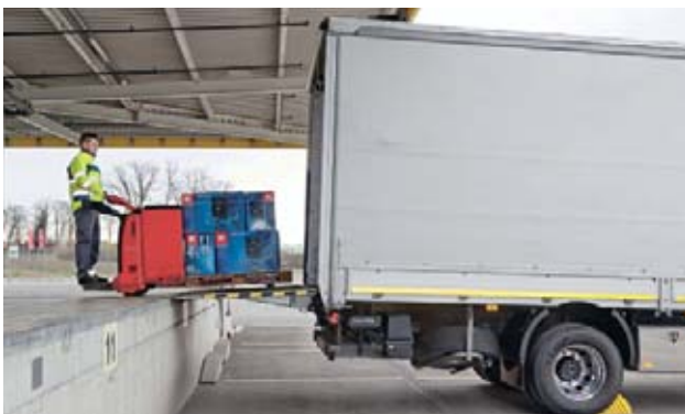
5 Fahrzeug gegen Wegrollen sichern (Keil).
