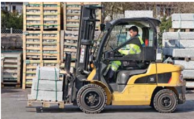
4 Last nah am Gabelrücken aufnehmen.
