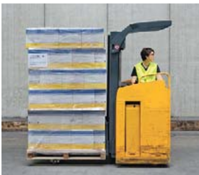
1 Ladungssicherung mit Stretchfolie
