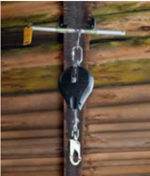
Regola 5 Usare punti di ancoraggio sicuri
