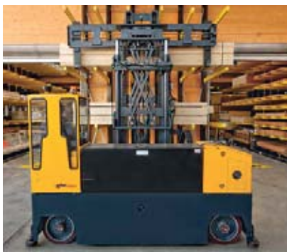
2 Chariot élévateur latéral pour le transport de charges longues
