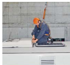
4 Travaux avec EPI antichute sur le toit d'un bus
