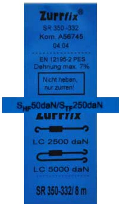
L'indicazione STF («Standard Tension Force») presente sull'etichetta fornisce informazioni circa la forza di pretensionamento ottenibile con un mezzo d'ancoraggio. Tale forza si ottiene manualmente mediante il tenditore secondo l'indicazione SHF («Standard Hand Force»).
