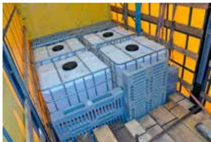
**Fissaggio del carico mediante accoppiamenti delle forme**
