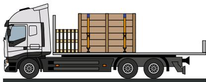
Se necessario inserire un distanziatore tra la parete frontale e il carico. In seguito ripristinare il fissaggio mediante accoppiamento delle forme in avanti utilizzando palette o altri mezzi ausiliari adeguati!
