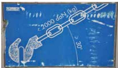
Sia nell'ancoraggio verso il basso che nell'ancoraggio diretto occorre tener conto della portata dei mezzi e dei punti d'ancoraggio sul veicolo!
