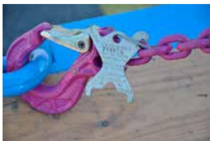
Le catene d'ancoraggio devono essere sottoposte a verifica conformemente alle indicazioni del produttore, di regola a scadenza annuale. L'etichetta di verifica periodica indica quando deve essere effettuato al più tardi il prossimo controllo.
