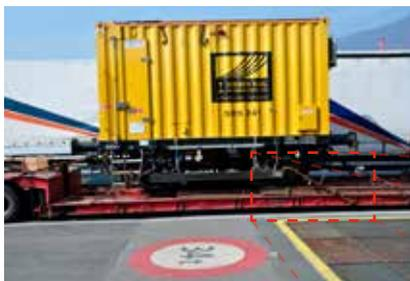
Nel caso di componenti pesanti, di regola si utilizzano catene d'ancoraggio o funi d'acciaio con tenditore a vite.
