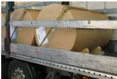
Cunei anteriori o posteriori per impedire il rotolamento di merci cilindriche. Importante: i cunei devono sempre essere fissati al piano di carico (p. es. cunei avvitabili).
