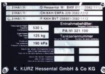
Auf einem Schild aus korrosionsbeständigem Werkstoff, das dauerhaft an einem für die Inspektion leicht zugänglichen Ort befestigt ist, müssen die zusätzlichen Kennzeichnungen nach ADR 6.5.2.2 angebracht werden. Ab 450 Liter sind zwei Gefahrzettel Nr. 3 und zwei Kennzeichen
