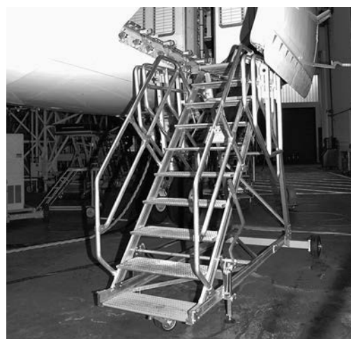
2 Escalier de maintenance protégé contre la mise en mouvement intempestive avec garde-corps baissés.
