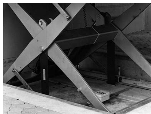
Fig. 9: avec les béquilles déployées, le personnel d'entretien est protégé contre un abaissement involontaire de la plate-forme.
