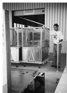
Fig. 3: cet opérateur dispose d'une bonne visibilité pour l'abaissement et l'élévation de la plate-forme.
