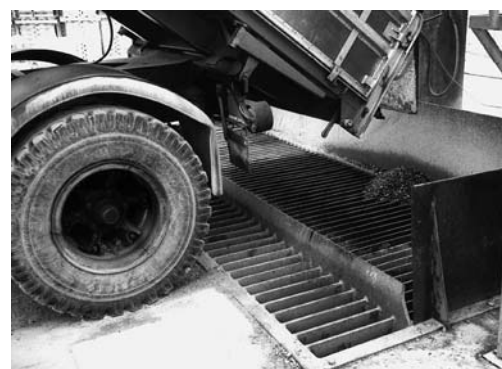
Figure 10: ouverture de déversement avec une grille sur laquelle le personnel de service ne doit pas circuler. L'écartement entre les barreaux ne doit pas faire plus de 80 mm. Si la grille est quadrillée (barres dans le sens de la longueur et de la largeur), cet écartement ne doit pas dépasser 150 x 150 mm.
