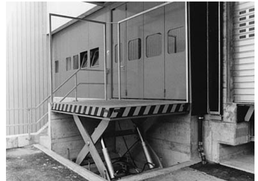
Bild 1: Beim Absenken der Hebebühne bewegt sich auch das Geländer nach unten und bildet eine Abstrankung für die oberen Zugänge.
