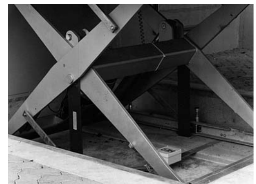
Bild 9: Bei ausgefahrenen Stützen ist das Instandhaltungspersonal gegen ein unbeabsichtigtes Absenken der Hebebühne geschützt.
