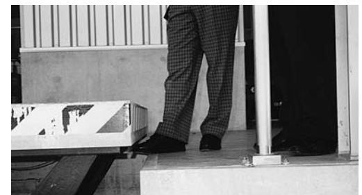
Bild 8: Kontaktleisten verhindern zum Beispiel, dass ein Fuss eingeklemmt wird.
