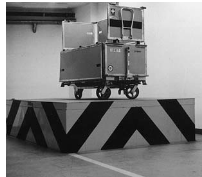
Bild 6: Schutzabdeckungen verhindern, dass nicht berechnigte Personen, z. B. Kinder, in den Raum unter der Hebebühne hineingehen.
